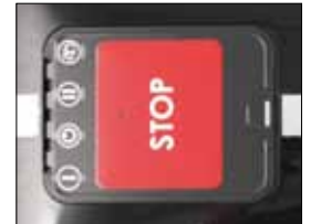
Tastiera con stop di sicurezza elettronico Keyboard with electronic emergency stop
